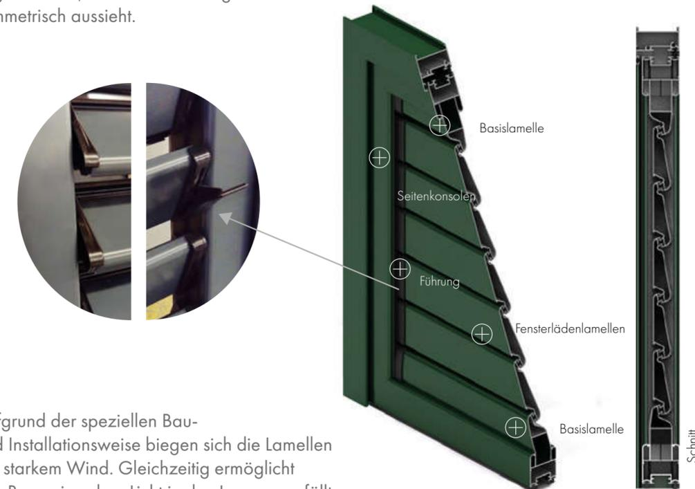
Aufgrund der speziellen Bau- und Installationsweise biegen sich die Lamellen bei starkem Wind. Gleichzeitig ermöglicht ihre Bauweise, dass Licht in den Innenraum fällt.
